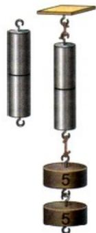
Рис. 26. Сплетение свинцовых цилиндров
