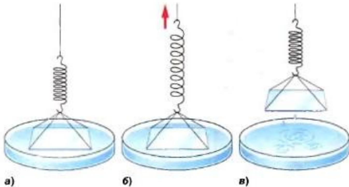
К пружине подвешивают на нитке стеклянную пластинку так, чтобы её нижняя поверхность была расположена горизонтально (рис. 27). Эту пластинку подносят к сосуду с водой так, чтобы она легла на поверхность воды (рис. 27, а). При отрывании пластинки от воды пружина заметно растянется (рис. 27, б). Это доказывает существование притяжения между молекулами.
